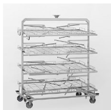
C983 Upp till 28 DIN korgar. 4 nivåer med 16 diskarmar. Mått mm (B X D X H) 920 x 1440 x 1770
