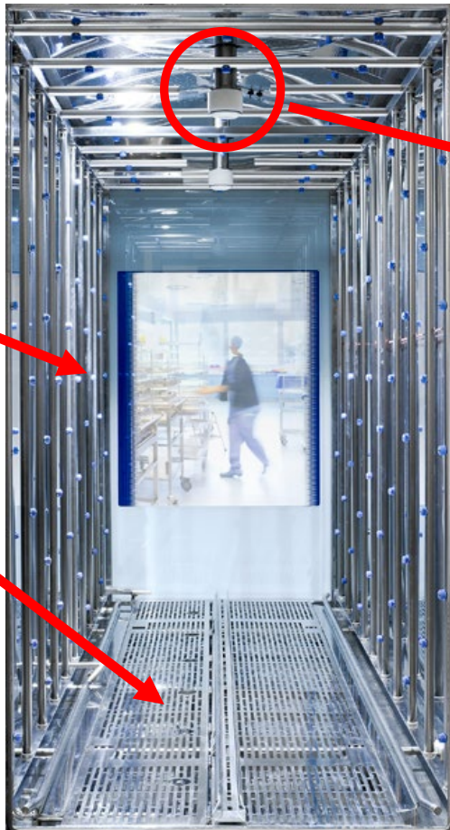
Självrengöringsfilter som spolar och fångar upp rester under tvättning.
